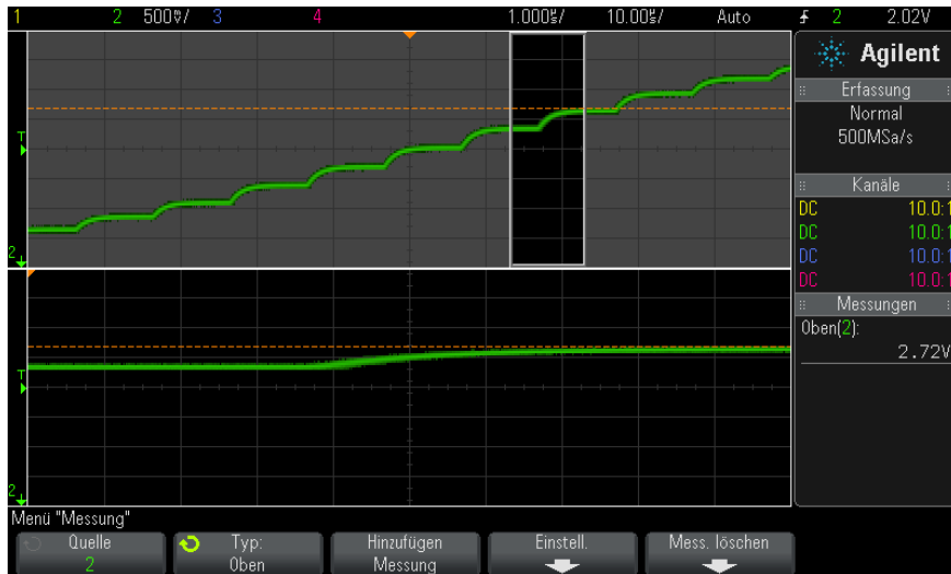
Abbildung 33 Isolationsbereich für Dachmessung
